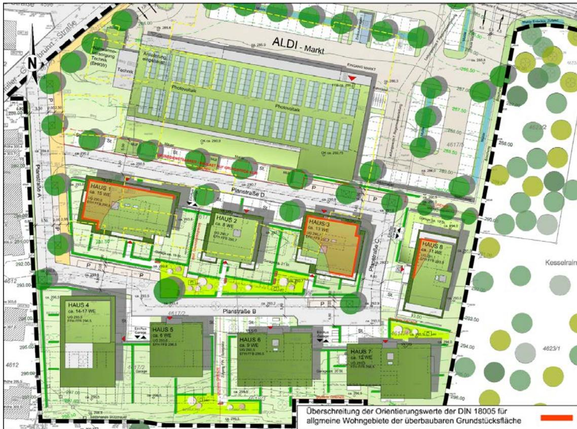
Abb. 15: Schalltechnische Untersuchung, Überschreitung der Orientierungswerte an den Baugrenzen, KARAJAN Ingenieure GmbH, Stuttgart, 08.02.2017
