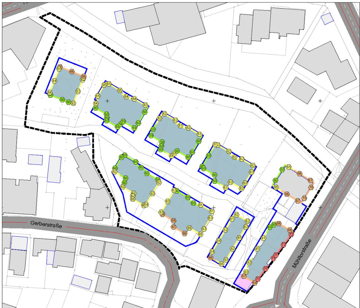
Abb.: Bereiche mit Festsetzungen zu Schallschutzmaßnahmen, Maßgebliche Außenlärmpegel DIN 4109 (Überlagerung Straßen- und Anlagenlärm), Anzeigetes Stockwerk: Höchster Pegel je Fassade
