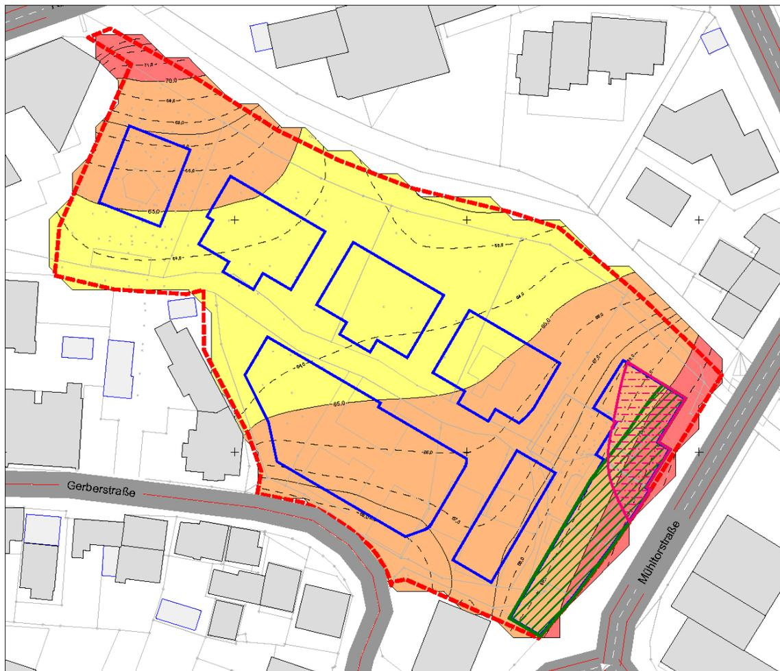
Abb.: Bereiche mit Festsetzungen zu Schallschutzmaßnahmen, Maßgebliche Außenlärmpegel DIN 4109 (Überlagerung Straßen- und Anlagenlärm)
